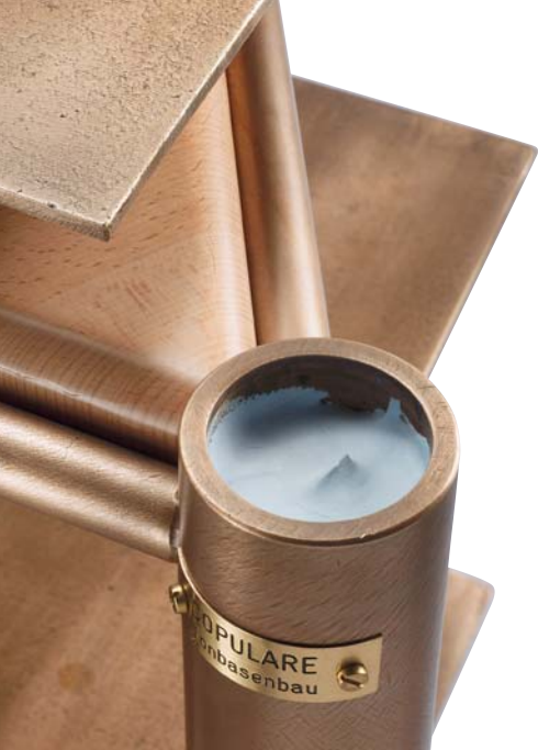
Damit das Rack nicht wie eine Glocke schwingt, sind seine vertikalen Säulen mit dämpfendem Dental-Gips befüllt
